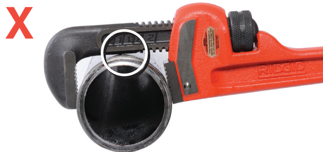
Figura 4 – La llave es demasiado pequeña para el tubo y el eje del gancho está tocando el tubo
