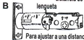
Para ajustar a una distancia de 2-3/4" (70mm) gire la lengüeta el sentido de las manecillas del reloj hacia abajo como se indica en la figura 'B'. Ahora el pestillo esta ajustado en la posicion de 2-3/4" (70mm).
