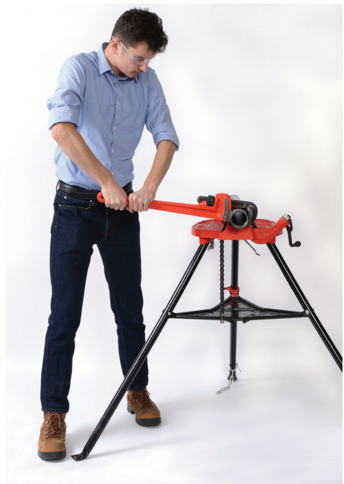
Figure 7 – Une position de travail appropriée
