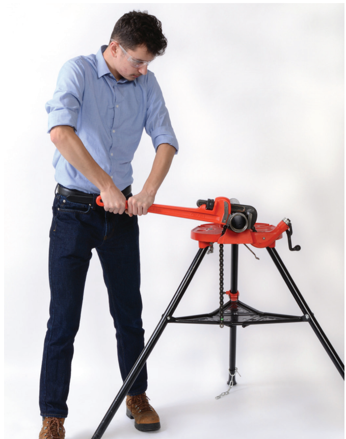
Figura 7 – Posición de trabajo correcta
