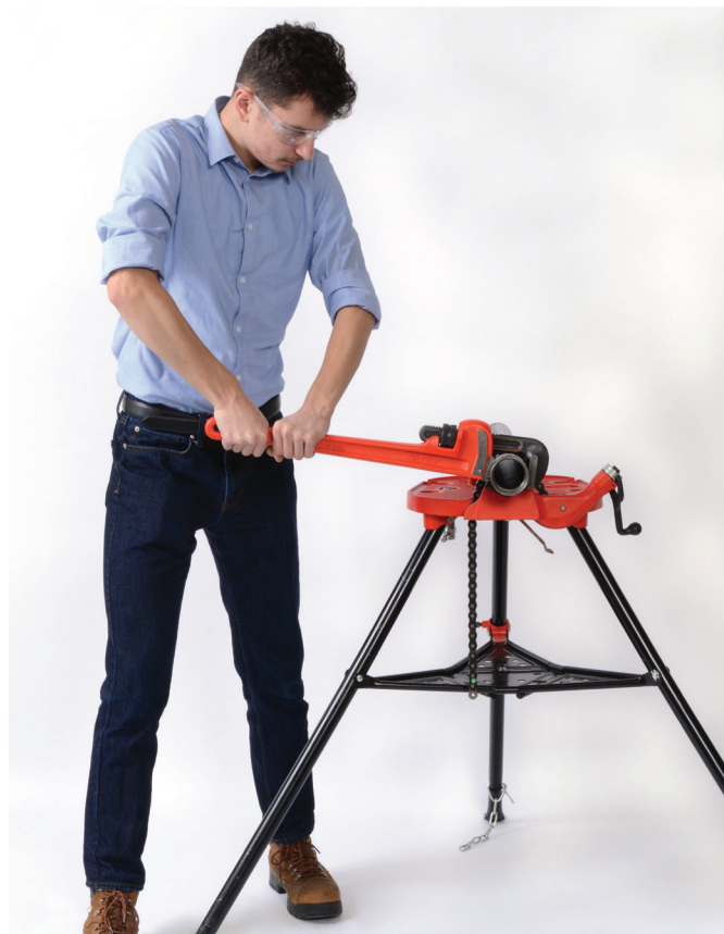
Figura 7 – Posición de trabajo correcta
