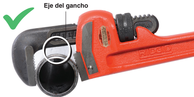
Figura 3 – Mantenga un espacio entre el eje del gancho y la pieza trabajada
