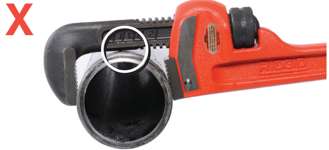
Figure 4 – Clé trop petite avec bras de mâchoire mobile en contact avec l'ouvrage
